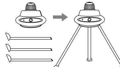
Připevněte talíř na ochranu motoru před vodou na spodní trup a následně spodní trup zašroubujte do vrchní části motoru a připojte na trup vrchní část sušičky. Spoj zašroubujte ve směru hodinových ručiček do vrchního trupu dokud nedosáhne své pozice.
